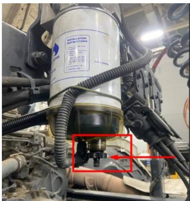
Фото 3. Сливной клапан на топливном фильтре ТС «МВ Actros»
