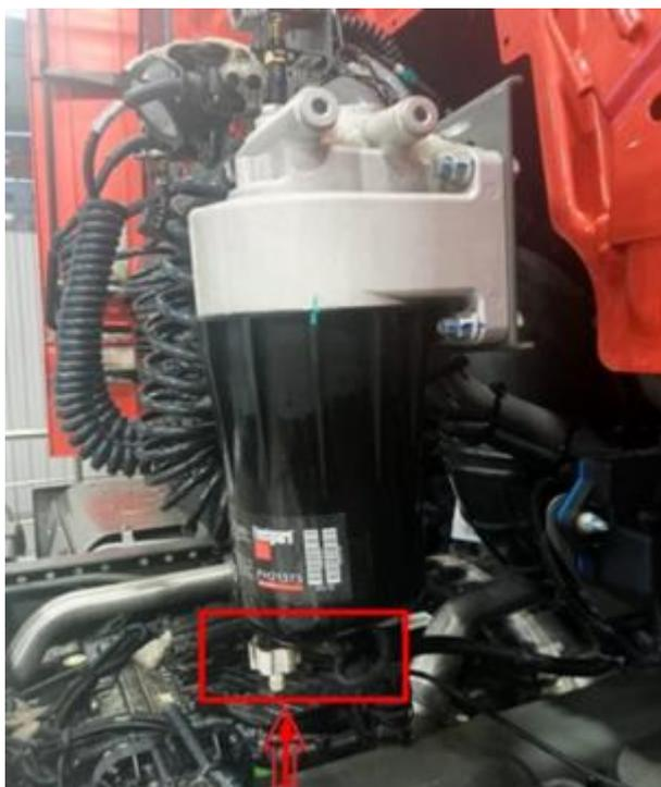
Фото 2. Сливной клапан на топливном фильтре ТС «SCANIA NTG – PDE»
