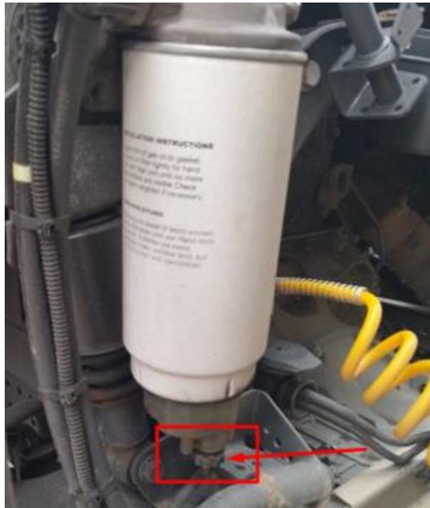
Фото 4. Сливной клапан на топливном фильтре ТС «FOTON AUMAN»
